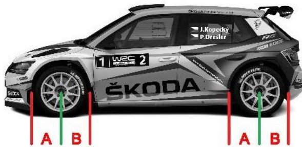
Esquema 2: La diferència entre la mesura A i la mesura B no pot ser superior a 5mm.
